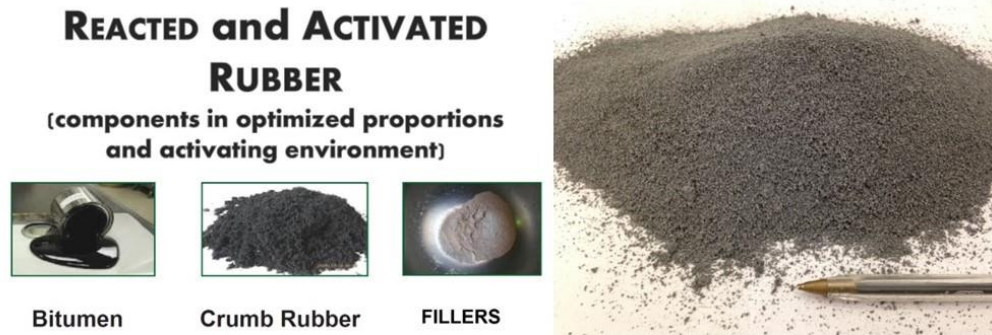
Figura 8. Componentes de caucho reaccionado y activado y producto en polvo (Bitumen, Polvo de Caucho e Fillers)
